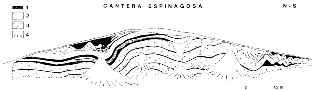
Figura 6: Corte ofrecido por la cantera de Espinagosa sobre los yesos del Keuper. Leyenda: 1) arcillas; 2) yesos arcillosos rojos de la Fm. del Molar; 3) yesos (anhidrita) de la Fm. Miravet; 4) derrubios del frente de la cantera. (Según SALVANY, 1986).
