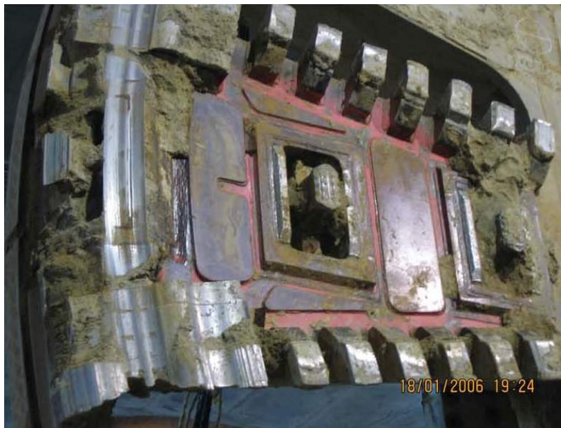
Figura 13: Detalle del desgaste en el borde de una cabeza de corte.
