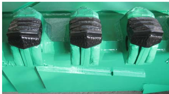
Figura 15: Detalle de picas de última generación con plaquitas de carburo tungsteno y soldadura de protección.
