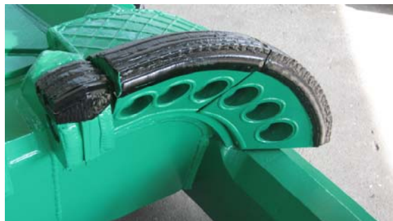
Figura 14: Detalle de un rastrel de última generación con plaquitas de carburo de tungsteno.
