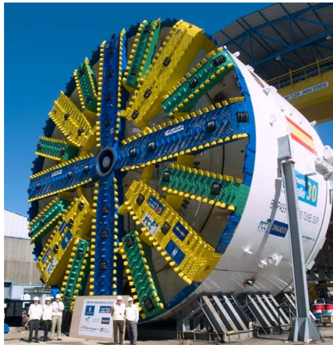
Figura 8: Escudo MITSUBISHI tipo “EPB” ( \varnothing_{exc} : 15,010 m) del Túnel Sur de Calle 30 (Madrid).
