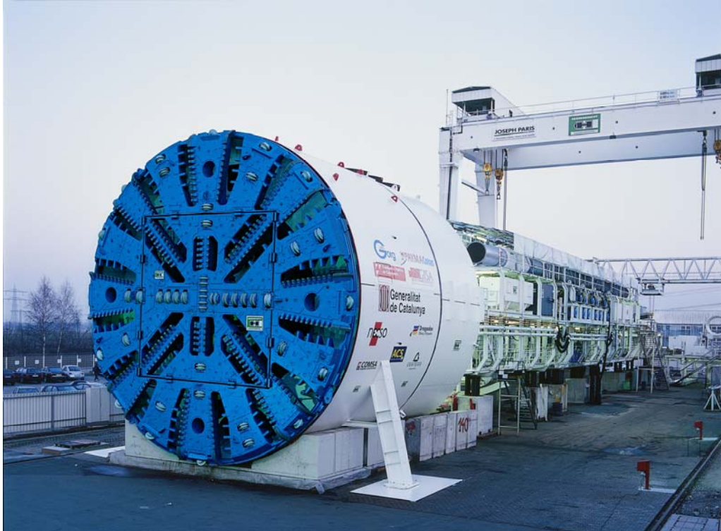
Figura 4: Escudo E.P.B. HERRENKNECHT ( \varnothing_{exc} = 12,06 m) de la línea 9 (Gorg – Sagrera) del Metro de Barcelona.
